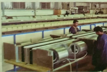
خط انتاج وحدات دفع الهواء (Fan Coil Units)
